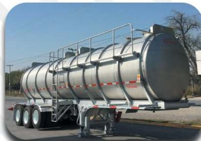
✓ **TANQUE DE PRESIÓN Y VACÍO**
